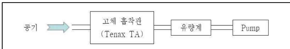
<그림 1-2> 휘발성유기화합물의 시료채취기 연결방법
